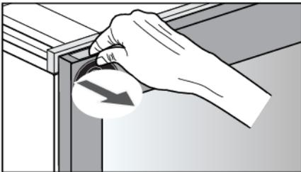
Если нажимной механизм не работает из-за сбоя электропитания, открыть дверь можно с помощью скрытой ручки.
