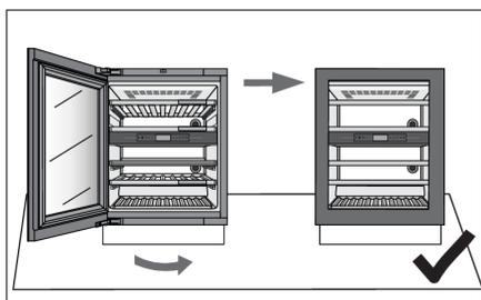
4. Края корпуса и двери должны быть параллельны.
