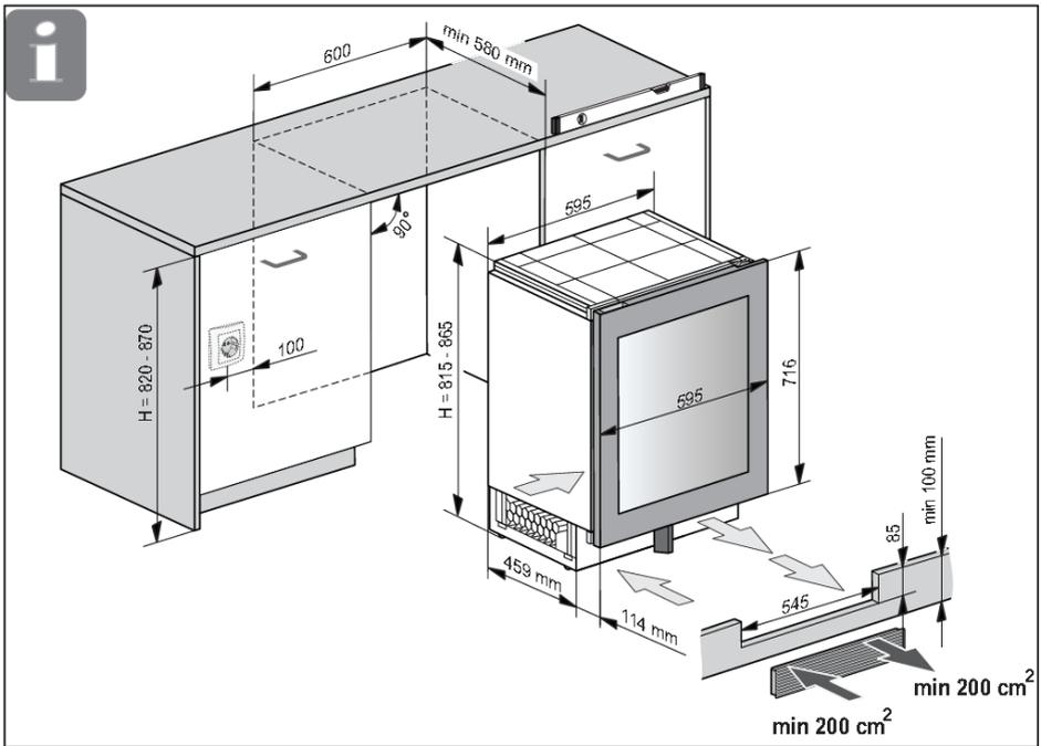
Вентиляция прибора осуществляется через отверстия в основании, поэтому не закрывайте отверстия. Кроме того, необходимо регулярно очищать отверстия от пыли.
