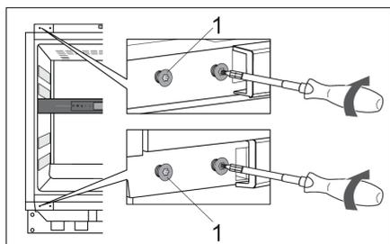
8. Вкрутите винты (1) в отверстия в верхней и нижней части с левой стороны корпуса, но не закручивайте полностью.
