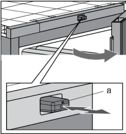
Штифт (а) нажимного механизма выдвинется вперед, и дверь откроется примерно на 6 сантиметров. Теперь можно открыть дверь полностью. Если не открыть дверь полностью, она автоматически закроется. Доводчик плавно закроет дверь.
