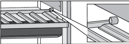
Полку можно частично выдвинуть (и извлечь) из прибора. Чтобы полка не упала, ограничители на стенках прибора предотвращают ее полное выдвижение и извлечение.
