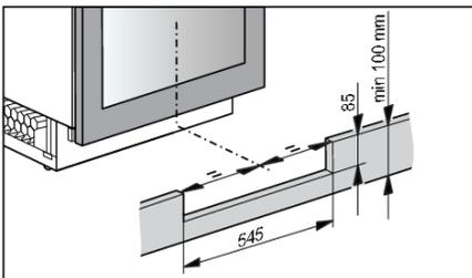
14. Подготовьте кухонный цоколь. Отверстие для вентиляционной решетки в кухонном цоколе должно располагаться по центру прибора. Это единственный способ обеспечить правильную работу прибора.
