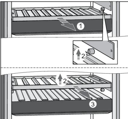
Чтобы снять полку, потяните ее на себя (1), пока пазы по бокам полки не совместятся с двумя ограничителями (слева и справа) на стенках прибора. Затем поднимите полку (2) и извлеките из прибора (3). Будьте осторожны, чтобы не повредить уплотнитель двери.
