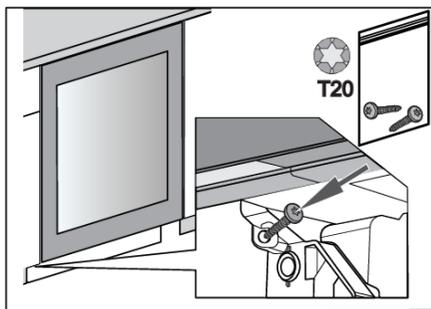
7. Прикрутите прибор к кухонному шкафу снизу, с противоположной стороны от шарнира.
