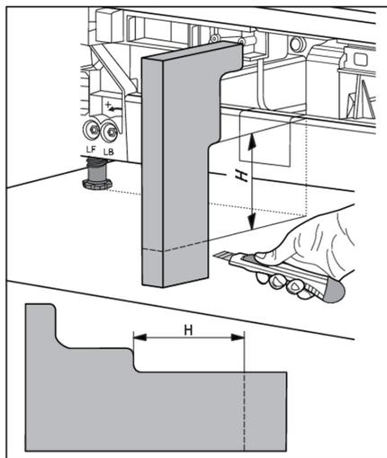
10. Измерьте расстояние H на приборе и отрежьте воздушную перегородку, как показано на рисунке.
