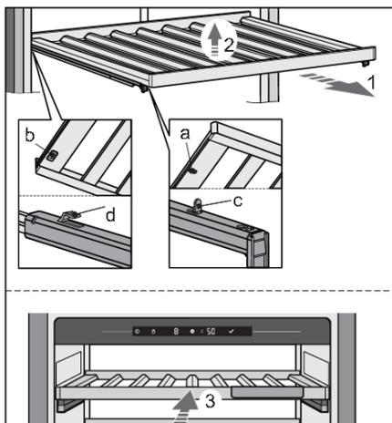
Чтобы извлечь полку из прибора, полностью выдвиньте телескопические направляющие (1), затем поднимите полку вверх (2) и снимите с направляющих. Будьте осторожны, чтобы не повредить уплотнитель двери. Углубления (a) и (b) в передней и задней части полки помогают устанавливать полку на направляющие. Чтобы установить полку, полностью выдвиньте телескопические направляющие и установите полку углублениями на фиксаторы в передней (c) и задней (d) части направляющих.
