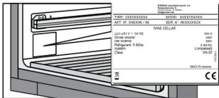
Устанавливать прибор следует в сухом, хорошо проветриваемом помещении. Допустимый диапазон температуры окружающей среды зависит от климатического класса прибора, который указан в заводской табличке.
