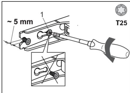
2. Не полностью (не более чем на 5 мм) открутите винты (1) верхнего и нижнего шарниров. Не откручивайте винты полностью. Так дверь будет прилегать к корпусу.
